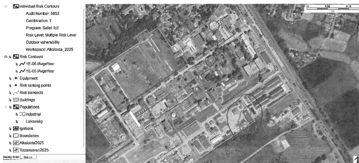
1. ábra: A halálozás egyéni kockázati görbéi – piros: 1E-5/év, kék: 1E-6/év – az ALKALOIDA Vegyészeti Gyár Zrt. telephelye körül (mérgező és tűzhatások együtt a robbanást is beleértve).
